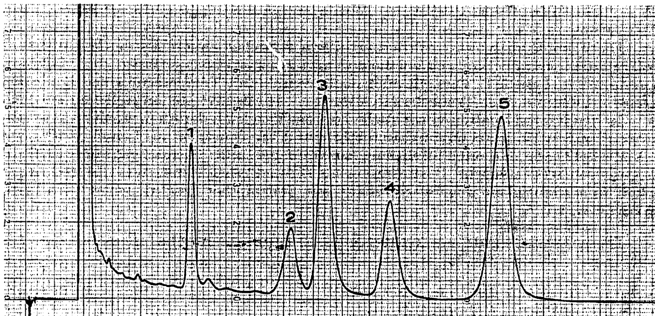
Fig. 1. Trennung der Fettsäuren aus Leinöl als Trimethylsilylester, 2 \mu l einer 3% Lösung in MSTFA. Gaschromatograph, Model 402 der Firma Hewlett-Packard; Ofen, 180°; Einspritzblock, 270°; FID, 280°; Trägergas, 45 ml/min; Glassäule, 3,5 m \times 3 mm I.D., 10% DEGS auf Diatoport S, 60–80 mesh (Hewlett-Packard); Potentiometer, 10^2 \times 32 . Zuordnung: 1 = Palmitinsäure (16:0), 2 = Stearinsäure (18:0), 3 = Ölsäure (18:1), 4 = Linolsäure (18:2), 5 = Linolensäure (18:3). Auflösung: R_{s18:0/18:1} = 1.13 .
